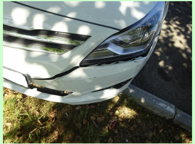
Фото 10. Трещина облицовки переднего бампера в левой части.
