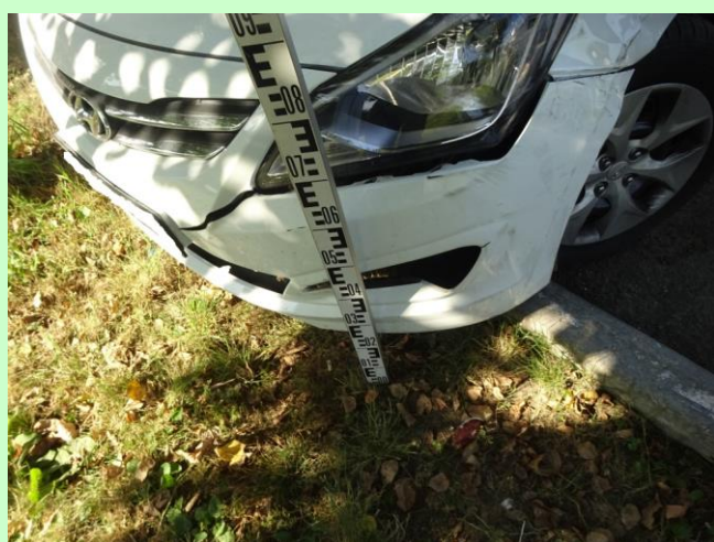
Фото 7. Общий вид повреждений. Фиксация высоты следов.
