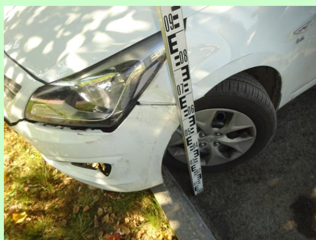
Фото 8. Общий вид повреждений. Фиксация высоты следов.
