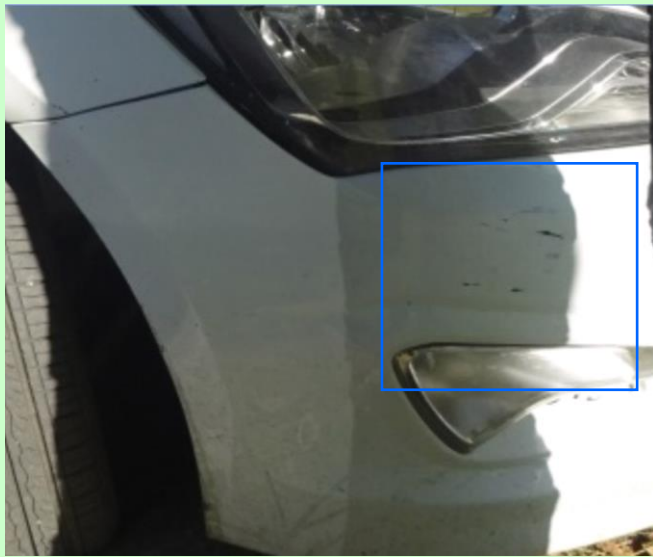
Фото 17. Повреждения облицовки переднего бампера в правой угловой части.
