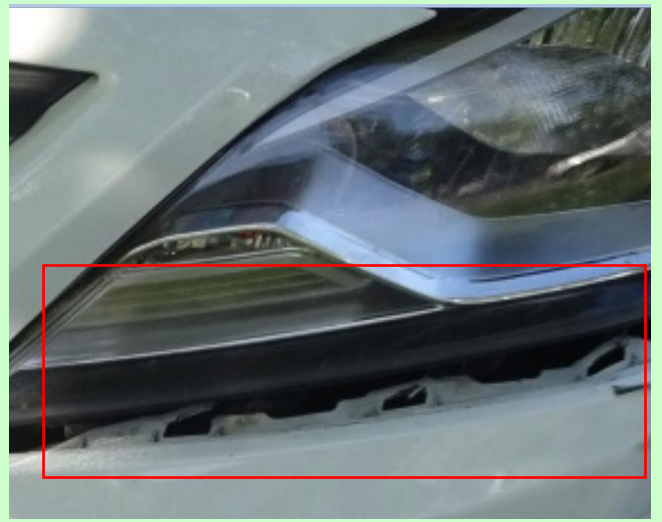
Фото 14. Трещины облицовки переднего бампера в левой части в месте сопряжения с левой блок-фарой.
