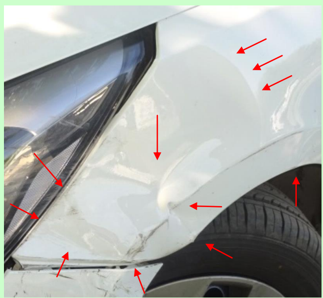
Фото 19. Деформация переднего левого крыла. Стрелками указаны заломы ребер жесткости.
