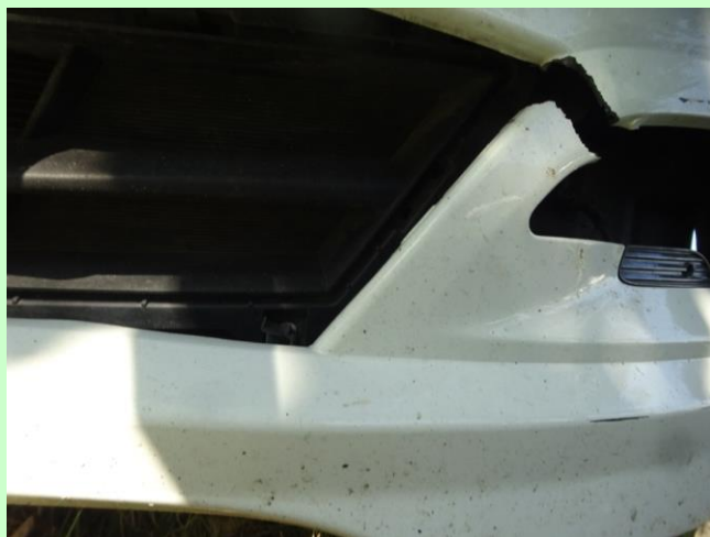
Фото 11. Трещина облицовки переднего бампера в левой части.
