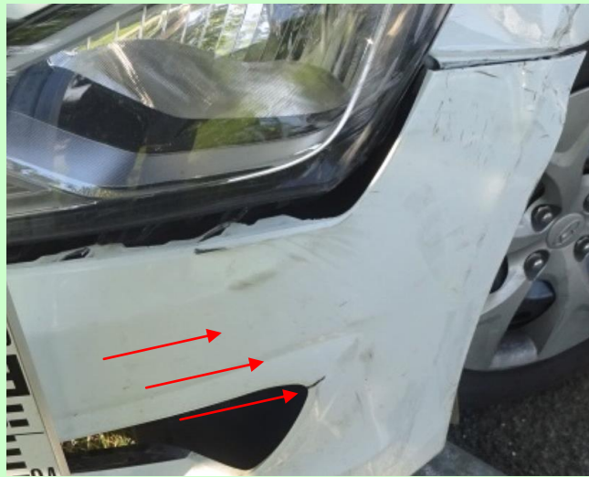
Фото 13. Повреждения облицовки переднего бампера в левой боковой части. Общее направление воздействия.
